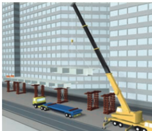
●大型搬送車による中央径間部桁一括架設
