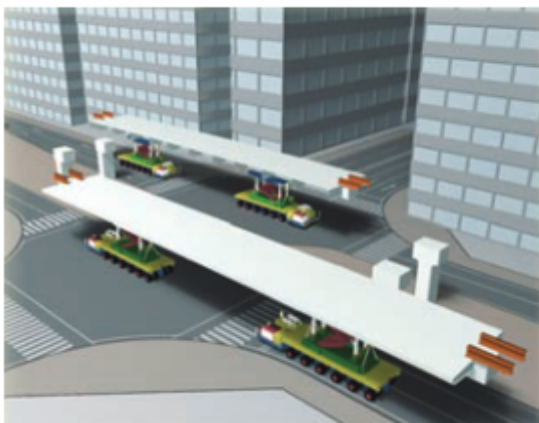
●盛土部での中央径間部桁地組立
