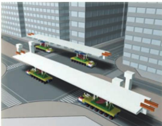
●大型搬送車による中央径間部桁一括架設
