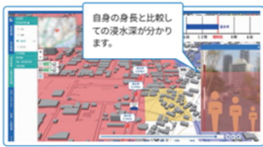
リアルタイム氾濫解析結果と浸水センサー情報 (追加機能) を表示
