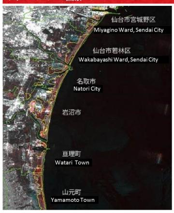
図は東日本大震災時の浸水域の抽出図です。黄色く囲われた場所が浸水域。官邸や防災関係機関に提供され溜まっている水の排水のためにどれだけ排水用ポンプが必要か、どの地域を優先すべきか等の判断材料や復旧計画に貢献しました。
