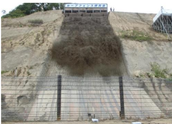
【Full-scale Test : Shallow landslide 100 tons】
