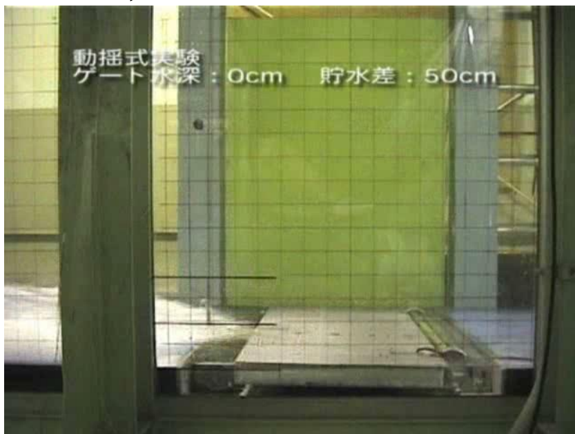
水槽実験：扉高 0.45m×幅1m
